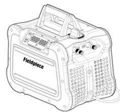
**HINWEIS:** Die vorderen Anschlüsse als Schlauchhalter und die hinteren Anschlüsse als Verteileranschlüsse verwenden.
