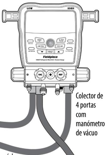
Coletor de 4 portas com manômetro de vácuo
